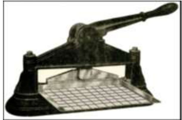
Fig. 2: Cummins perforator with 10 dies on the head. Fig.2: Perforador Cummings con diez dados en línea.
